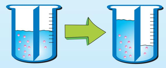
Ponendo ai lati di una membrana semipermeabile (permeabile all'acqua ma non ai soluti) due soluzioni a diversa concentrazione salina, si verifica il passaggio di acqua dalla soluzione meno concentrata a quella più concentrata.
